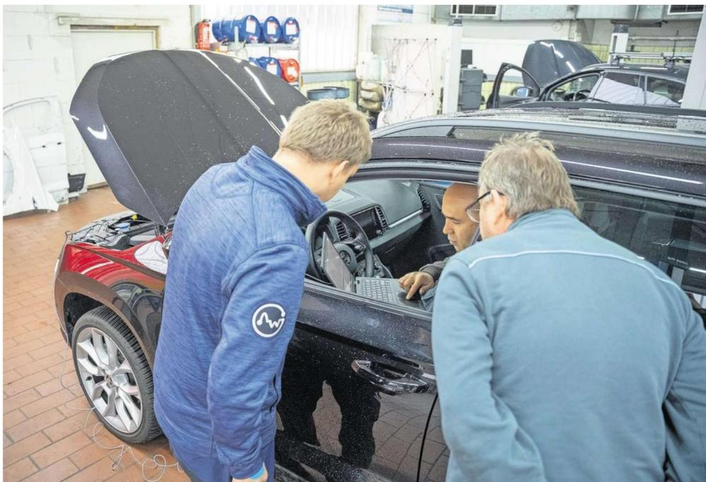
Mit Hilfe bereitgestellter Diagnosewerkzeuge messen die Handwerker die Spannungen der Batterie beim Starten des Motors. Foto: Keck
